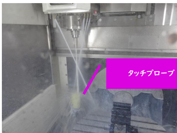
大量のクーラントがプローブに降り注ぎます。
