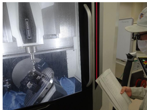
測定中にテーブルBC軸が傾くので、その瞬間は緊張します
