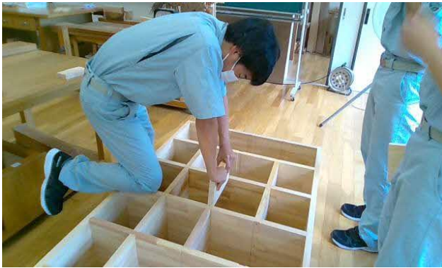
横板を差し込む様子
