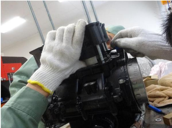
狭い隙間から、ピストンリングを縮めてシリンダに押し込みます。
