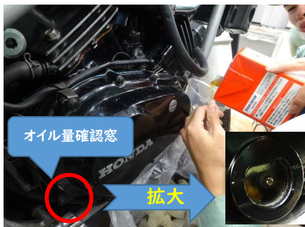
確認窓で量を見ながらオイルを注入。
