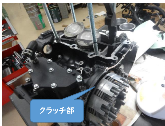
ピストンやクランクの回転への影響を確認しながら組み立て。
