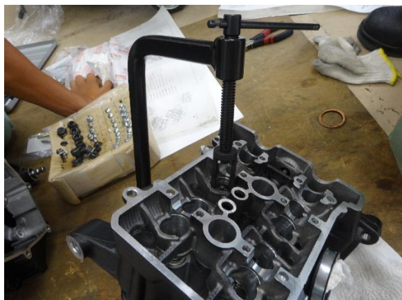
専用工具でバルブのスプリングを縮めます。
