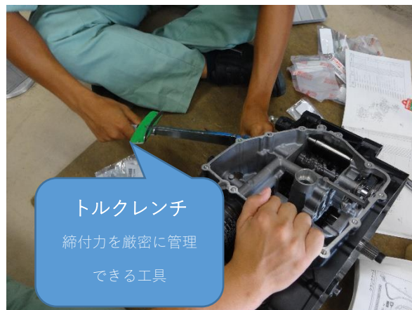
重要なボルトは締付力の指示があるので、専用工具を使用。
