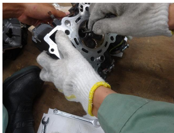
エンジンの内部側からバルブを差し込みます。
