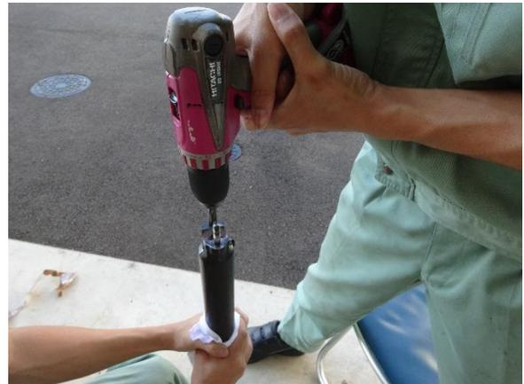
最終手段で、ネジを破壊して分解します。
