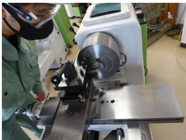
Y君とW君で旋盤を使って、寸法の修正をしました
