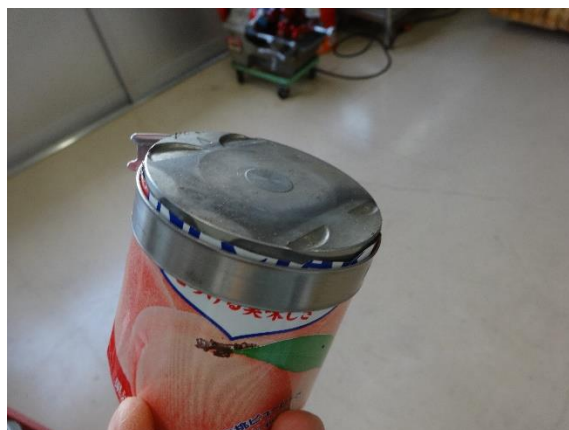
空き缶とホースバンドでピストンリングを縮めます
