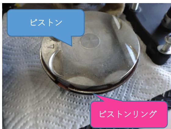
ピストンよりピストンリングの径が大きいのがわかります
