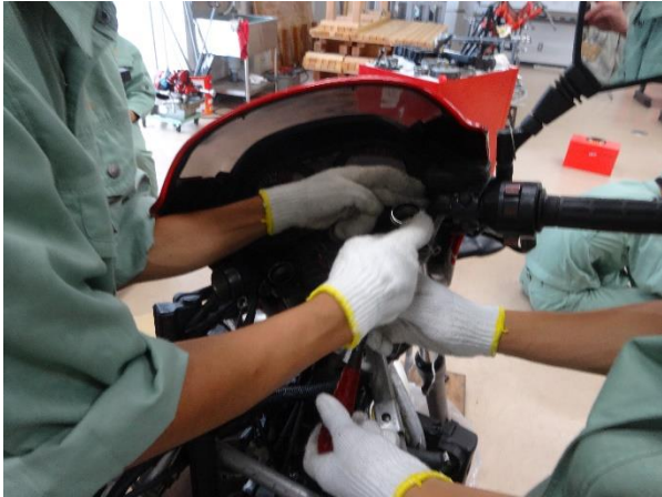
まず車両からフロントサスペンションを外します
