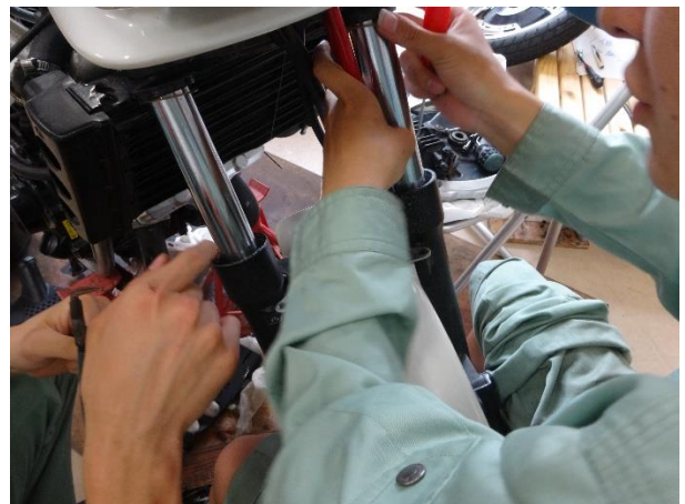
内部にあるクリップを特殊工具で外します
