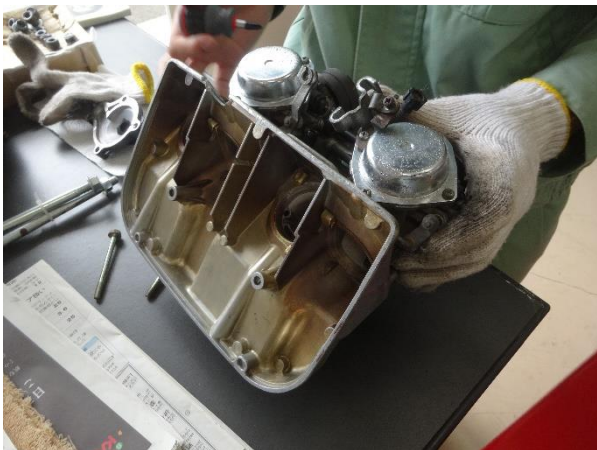
キャブレターの点検を実施
