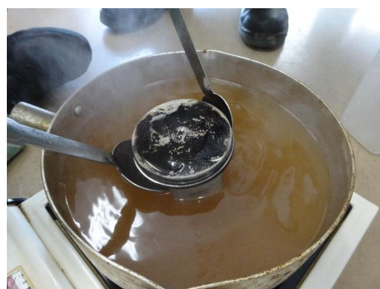
洗浄途中のピストン。だいぶ汚れが落ちてきています
