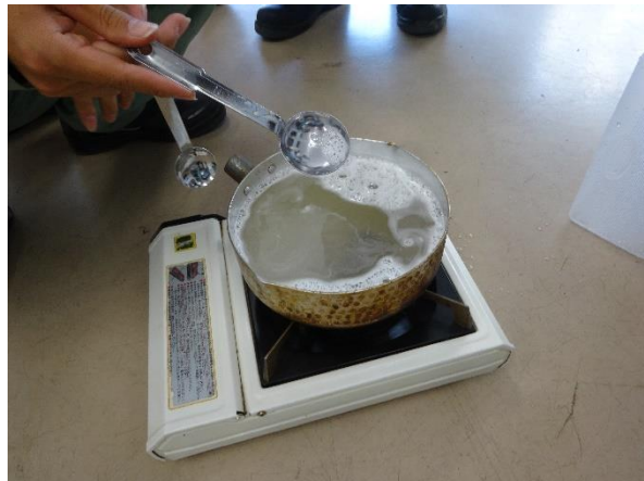
洗浄液を加熱し、洗浄力を向上させます
