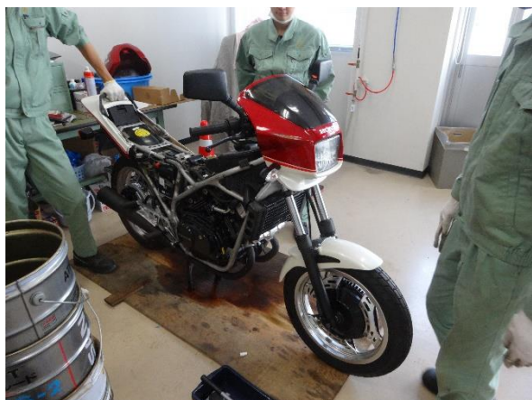
試運転に不要なパーツを外し、確認しやすくします
