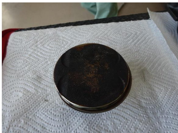
洗浄前のピストン。黒いカーボン汚れが付いています
