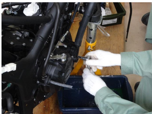
冷却水を循環させるポンプを外して冷却水を抜き取ります
