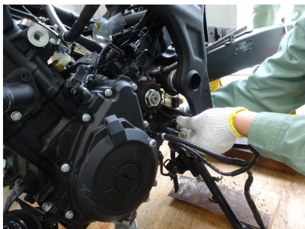
エンジン固定のボルト類はとてもきつく締め付けられていました
