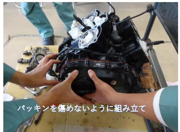
車体班は、先週に引き続きシリンダブロックとシリンダヘッドの間に入れるガスケットを製作しました。前回は直径5mmの穴をポンチと言われる工具で打ち抜いていましたが、だんだん切れ味が悪くなり、また時間がかかるので、電動ドリルを使う方法に変更し、効率UP！ 薄い銅板は扱いが難しいです。
