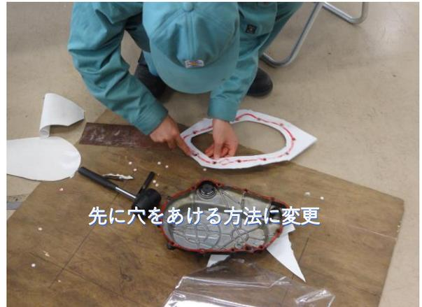
今回製作したパッキンと金属部品の接触面に、耐熱液状パッキンを塗って組み立てを行いました。
