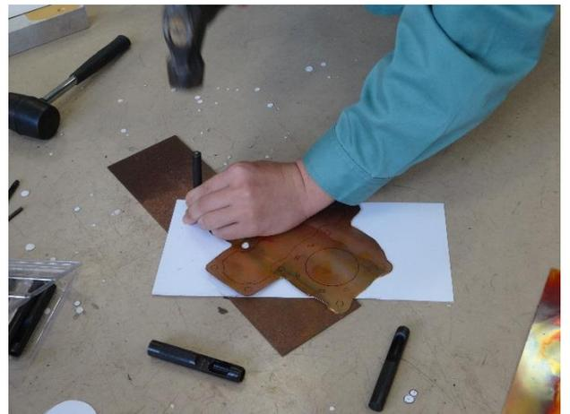
クラッチ等を規定のトルクで締め付け、カバーを取り付けようとしたところで、パッキンが破損していることに気づきました。ここは熱や圧力がそれほどかかりませんので、通常のパッキン材で自作します。パッキンの完成は来週に持ち越しです。
