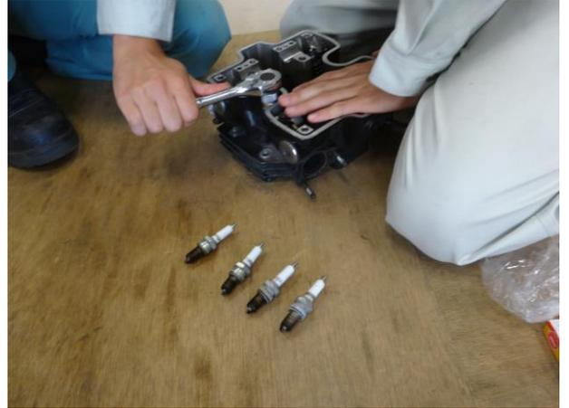
車体班は、シリンダブロックとシリンダヘッドの間に入れるガスケットを銅板で製作しました。外したものは剥がれがあり、しかも新品が入手不可能なためです。銅を使うのは、高圧・高熱で使用するためです。前回熱を加えて柔らかくした銅板に、ガスケットの形状を写し取り、加工していきます。穴はポンチで空けます。
