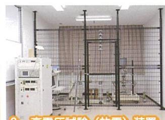
6 高電圧試験 (放電) 装置
