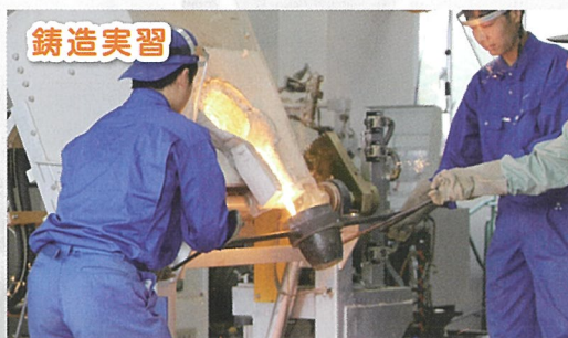
1500度の熱で鉄を溶かし、型に流し込み作品をつくります。
