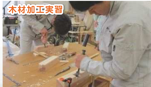
ノミやノコギリを本格的に使用して、木材を加工する実習です。建築大工に必要な技術、知識の習得を目指します。安全第一！！
